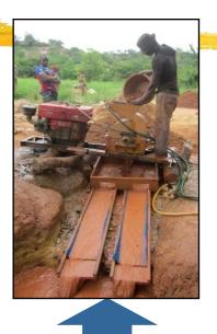
Lavage au sluice 300 kg/j 7500 CFA/J
